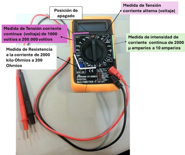
Figura 21. Partes de multímetro y lo que miden. Maletín AULA solar fotovoltaica (Cebekit, 2025)
